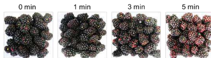
Figura 1. La vibración (frecuencia entre 10 y 15 Hz, aceleración de 0.5 g) por 5 min induce la reversión de color en frutos de zarzamora. Fuente: Elaboración propia.
